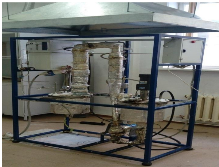
Сурет 7- Ауыр мұнай қалдықтарын металсыздандыру және күкіртсіздендірудің ірілендірілген зертханалық қондырғысы
